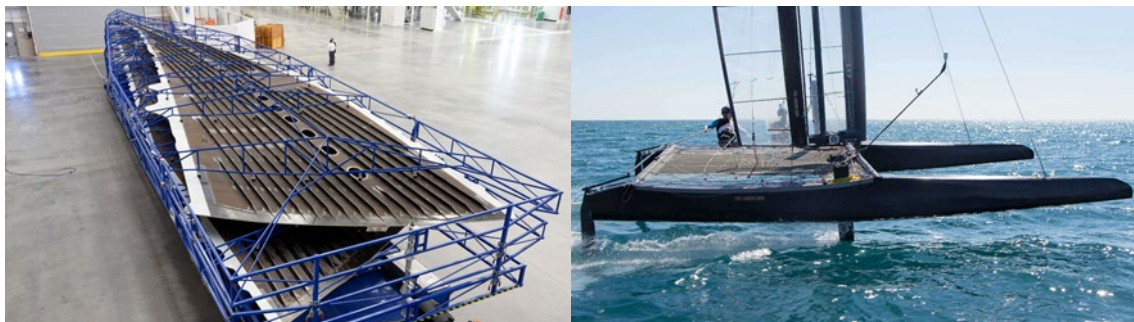
Figure 6 - Eléments d'aile de l'Airbus A350XWB fabriqués en carbone pré-imprégné Source : airbus.com Catamaran Classe C de Hydros.ch réalisé en pré-imprégnés NTPT pour la petite coupe de l'America 2015 Source : decision.ch
